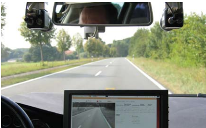
Fahrerassistenzsystem DRIVSCO: Monitor zur Überprüfung des Straßenverlaufs.
