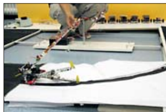
Der vergebliche Versuch, einen Berg zu ersteigen: Mit dem Laufstil aus der Ebene stürzt der Roboter „Runbot“ nach wenigen Schritten. Fotos: Schrader
