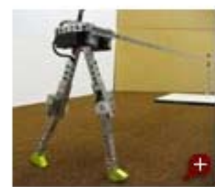
"RunBot" muss mit einer Führungsstange gestützt werden
